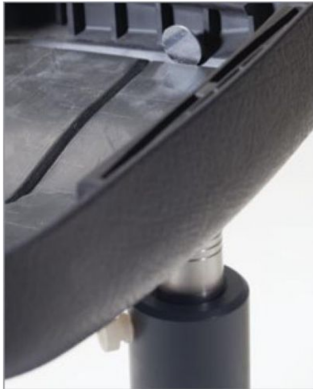
Figura 2. Posicionamento da sonda na parte externa de uma tampa de airbag.
